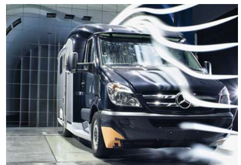
Test i vindtunnel hvor luften glider af
